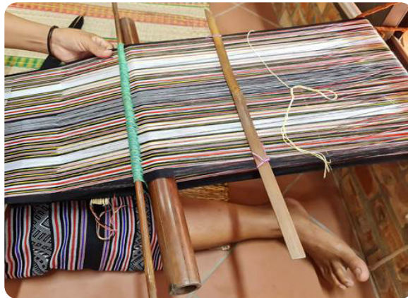
Hình 17. Công đoạn se chỉ vào khung
